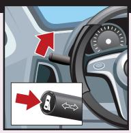
TO ACTIVATE, USE THE TURN SIGNAL OR PRESS A BUTTON ON THE TURN SIGNAL LEVER
